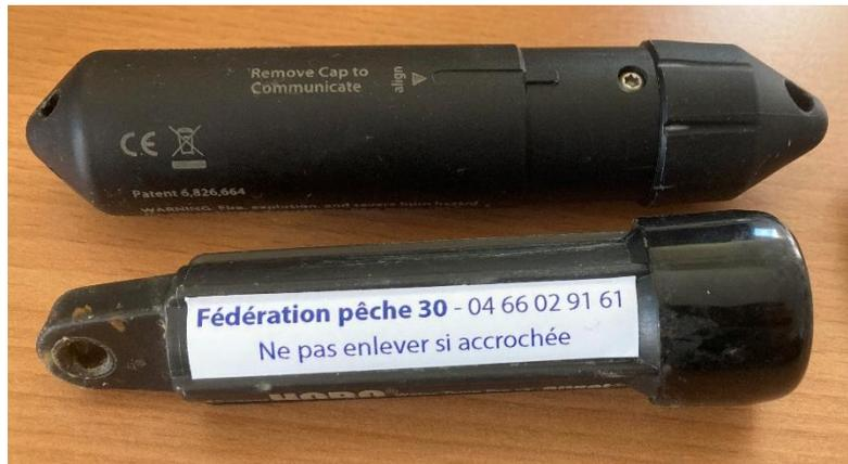
*Figure 74 Nouvelles sondes thermiques de la FDPPMA30*
