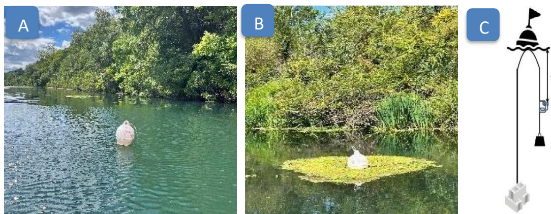
Figure 6: (A) Boué témoin en chenal en T2, (B) Boué entourée de macrophytes dérivants, (C) Schéma de la mise en place des sondes
